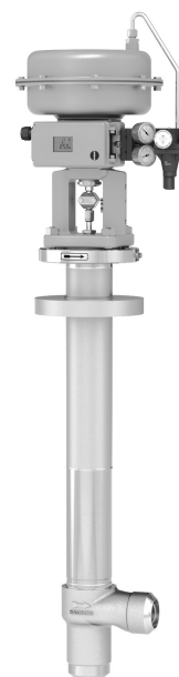
Bild 3: Pneumatisches Stellventil Typ 3248-7, Aluminium-Eckventil mit Stellungsregler, Druckregler und zusätzlicher Handverstellung, Sicherheitsstellung „Ventil geöffnet“
