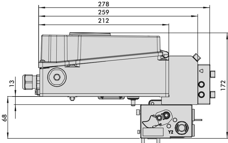
**Anbau an Schwenkantriebe nach VDI/VDE 3845**
