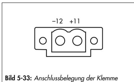
Bild 5-33: Anschlussbelegung der Klemme
