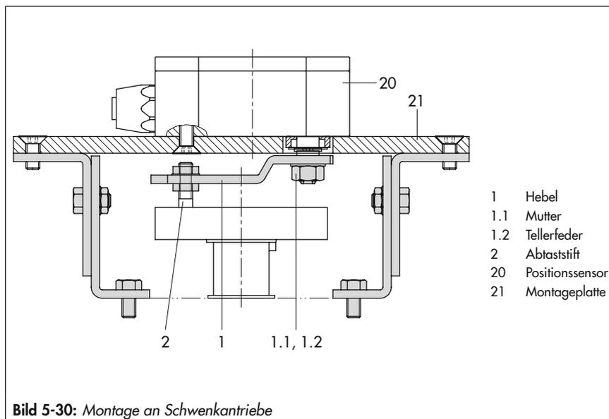
Bild 5-30: Montage an Schwenkantriebe
