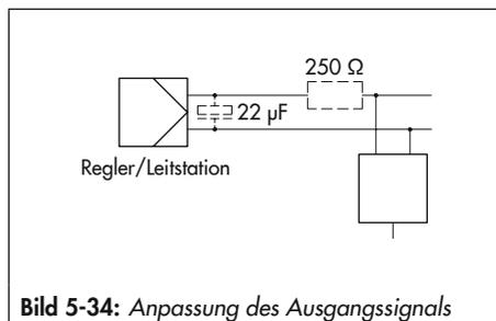
Bild 5-34: Anpassung des Ausgangssignals
