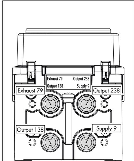
Bild 5-31: Pneumatische Ausgänge
