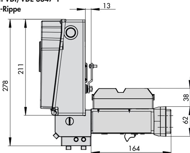
**Anbau an Schwenkantriebe nach VDI/VDE 3847-2**
