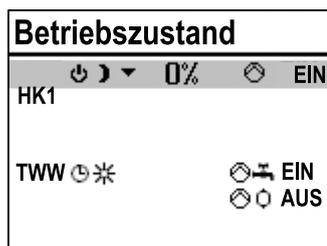
Drehesalter in die Schalterstellung ☉ „Betriebsarten“ drehen. Es werden die Betriebszustände aller Anlagen-Regelkreise angezeigt:
