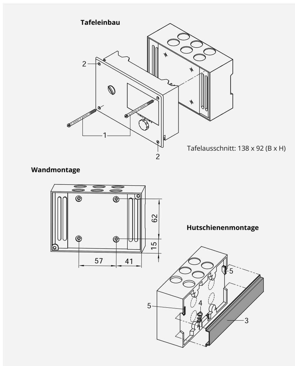
**Bild 2:** Montage · Maße in mm
