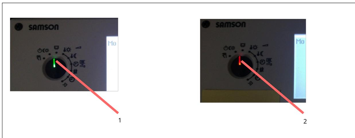
**Bild 11:** Anzeige einer Störung am Drehschalter
