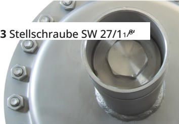
Bild 1-2: Hilfssteuerventil, Ansicht von oben auf die Stellschraube zur Sollwer-teinstellung
